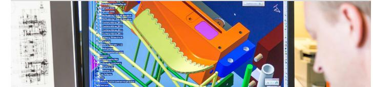
Die Werkzeugkonstruktion (CAD) erfolgt auf Basis von CATIA V5, anhand Ihrer Bauteil-daten unter Berücksichtigung der prozesstechnischen Rahmenbedingungen.
